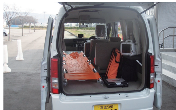
ドクターカーと搭載機器 （超音波エコー、血液ガス測定装置、AED、ストレッチャー他）
